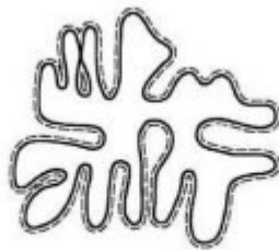
Bild 2 — Schematische Darstellung der Oberfläche eines Partikels, die mit der Adsorptionsmethode erfasst wird (siehe gestrichelte Linie)
