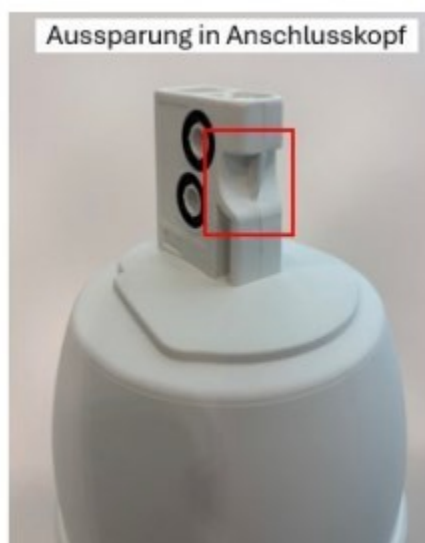
Abbildung 11: Aussparung in Anschlusskopf
