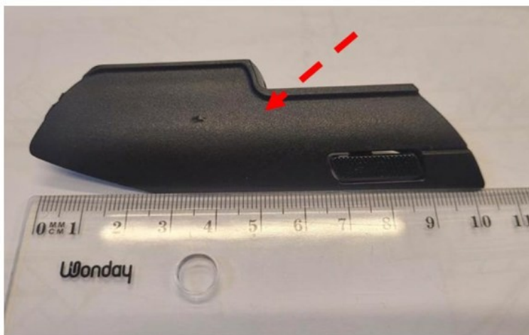
Figure 73 : adaptateur MOPAR (flèche rouge, photo du haut) et adaptateur BYD (flèche orange, photo du bas) positionnés à côté d'une règle graduée de manière à faire apparaître leurs dimensions longitudinales identiques
