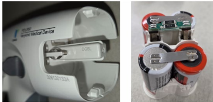
III. 4 Batterie-Dock (links) und Batterieeinheit mit Ablassabfluss
