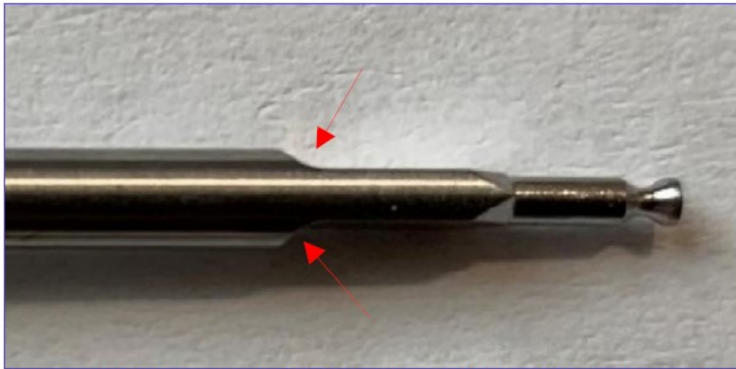
Proximaler Abschnitt des Werkzeugschafts des „Bojin Diamantfräasers“ (vgl. S. 34 der Klage) mit Kenntlichmachung der Fräskuhlen
